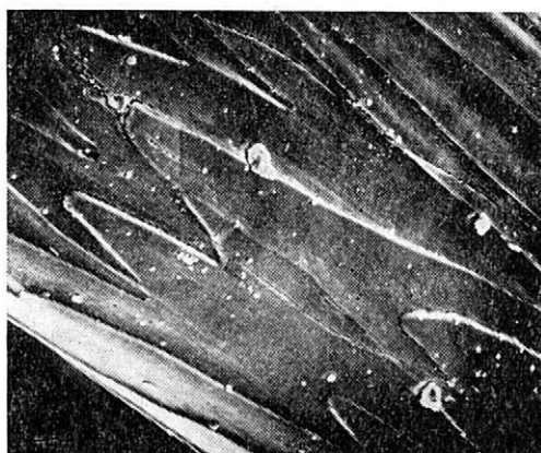
8. Osiník angorské srsti a detail tvaru buněk kutikuly (zvětšeno 2000krát) — Angora guard hair and detailed view of cuticle cell form (magnif. 2000 times)
