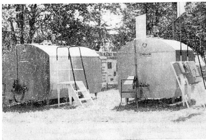
2. Chladicí zařízení na mléko ZD 6-014 (Strojbal-Pacov) — The ZD 6-014 milk cooling facility (Strojbal Pacov)
