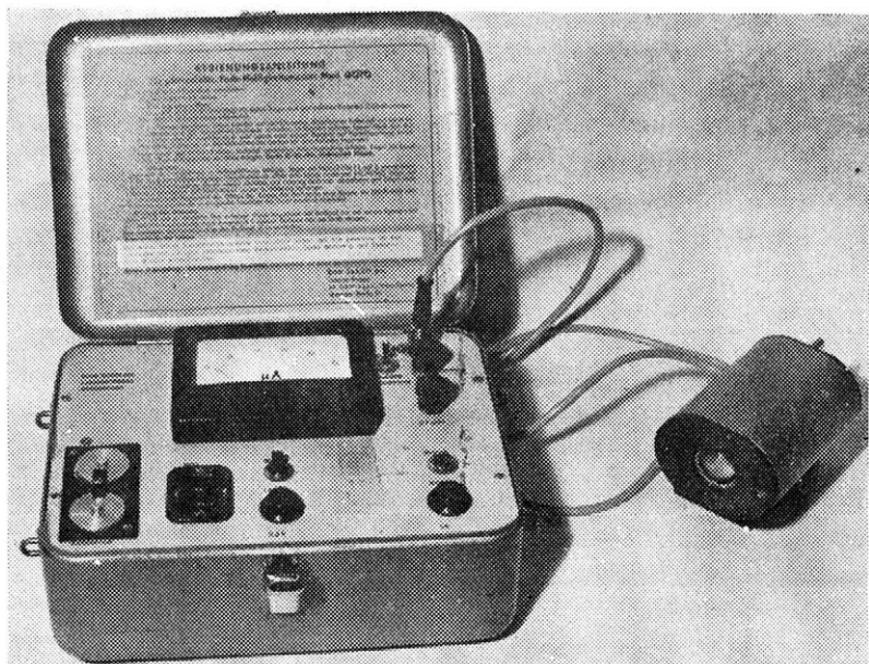
1. Fotoelektrický přístroj zn. Göfo s vestavěným mikroampérmetrem. — The photoelectric apparatus of the trade mark Göfo with a built-in microampere-meter
