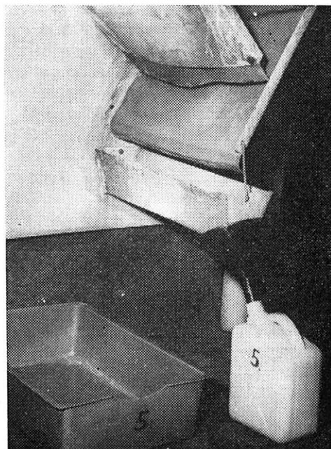
7. a 8. Detailní pohled na kolektor a separátor výkalů pro prasničky se sestavou sběrače moče a jímače tuhých a tekutých výkalů. — Detailed view of the collector and separator of excreta for gilts with a set of the urine collector and catching devices for solid and liquid excreta
