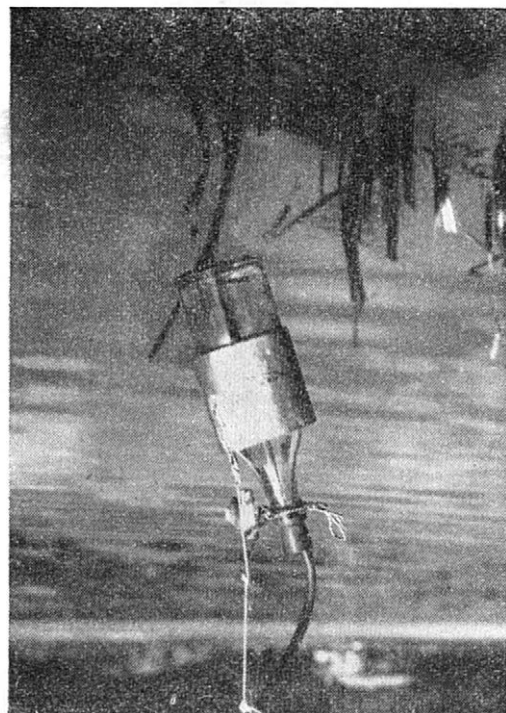
Obr. 4. Odběr vzorků vody do láhve (s patentním uzávěrem) zatěžkané lehce snímatelným olověným kruhem. Vtékání vzorku vody do láhve je upraveno dvakrát pro-vrtnou zátka.
