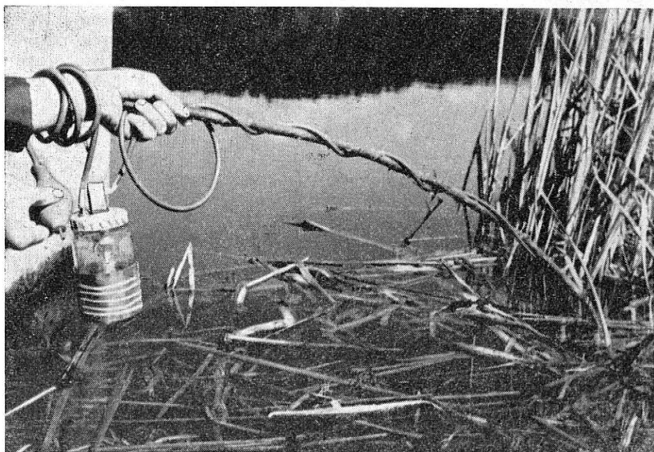
Obr. 3. Odběr vzorků vody, přičemž z místa odběru je vzorek do láhve nasát přes gumovou hadičku.
